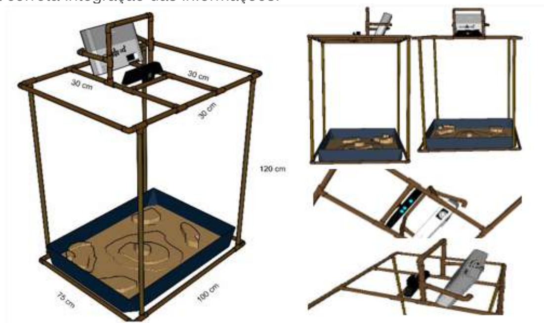
Figura 1: Modelo 3D da estrutura em PVC. (Fonte: O autor)
