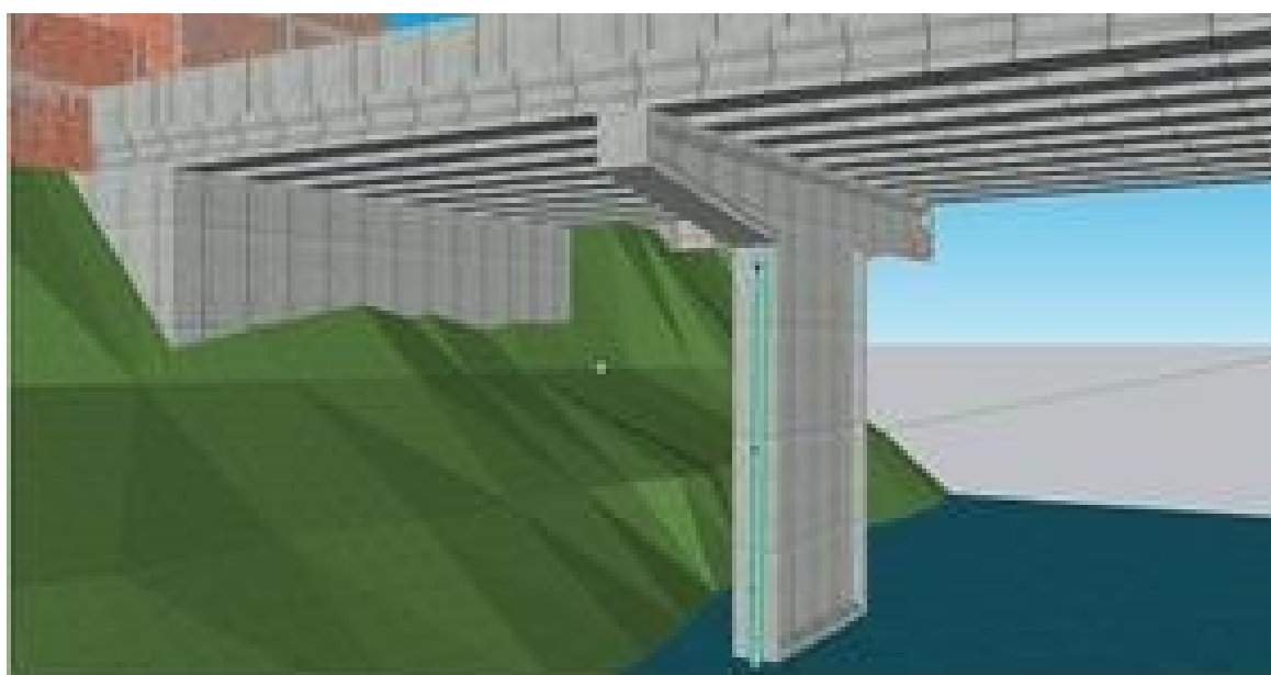
FIGURA 4 – Imagem da instalação do cabeamento e sensores de níveis junto ao rio Fonte: Elaboração própria pelo software Sketchup, 2021
