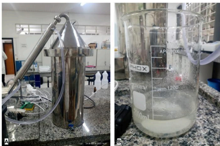
Figura 11 - Extração por arraste a vapor A) Extrator B) Béquer coletando Hidrolato + óleo essencial
