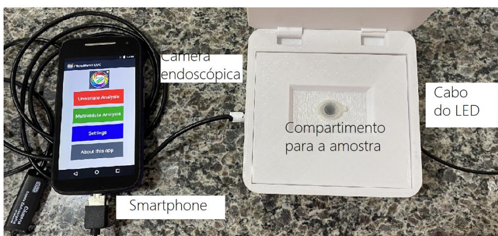
Figura 10. Montagem do Espectrofotômetro alternativo de impressão 3D
