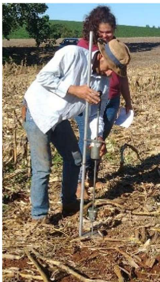
Figura 6 - Coleta de Resistência Mecânica a Penetração, com o uso de Penetrômetro de Impacto.
