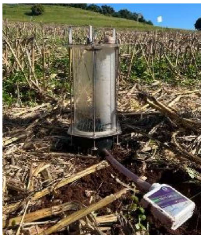
Figura 5 - Coleta de dados da taxa de infiltração, com o uso do Infiltrômetro de Cornell.
