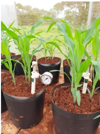
Figura 2: Utilização do tensiômetro para avaliação de umidade do solo.
