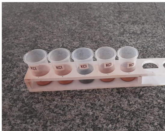
Figura 5: Amostras de solo com KCl em repouso.
