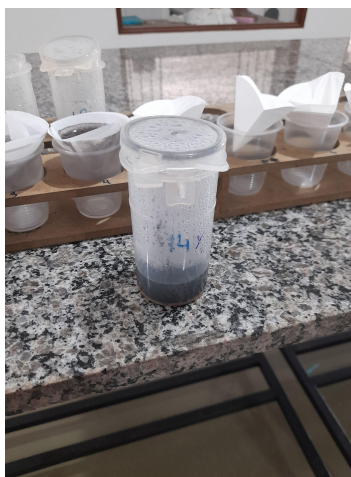
Figura 8: Filtragem das amostras das análises de Boro.
