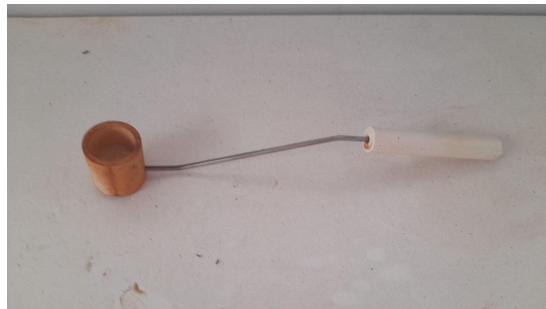
Figura 1: Cachimbo para retirada de amostra.
