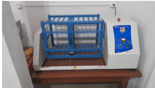
Figura 10: Agitador para análises físicas.
