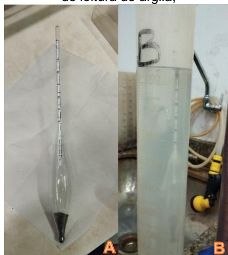
Figura 5 - A: Densímetro de análise de solo utilizado nas amostras físicas de solos; B: Demonstração de leitura de argila;
