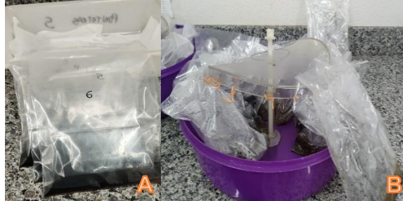
Figura 7 - A: Amostras de Boro nos saquinhos com solução de BaCl_2 ; B: Bateria com quatorze amostras de Boro para aquecimento no micro-ondas;
