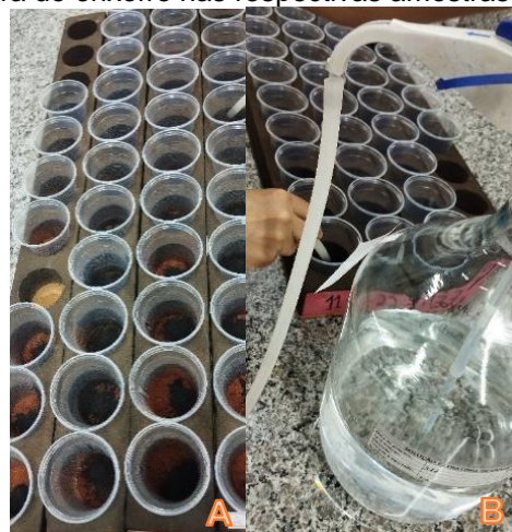
Figura 10 - A: Amostra de enxofre cachimbada com carvão ativado; B: Dispensa da solução extratora do enxofre nas respectivas amostras;
