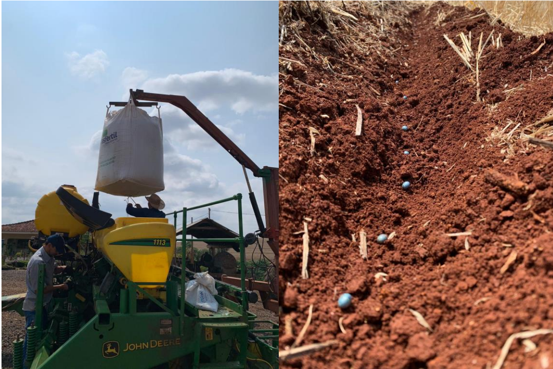
Figura 4: Regulagem da plantadora.
