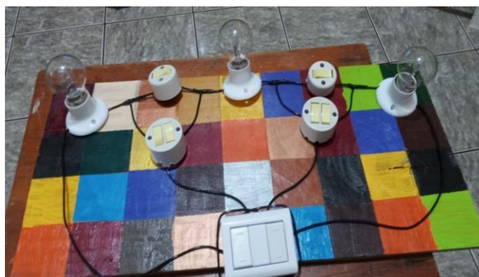
Figura 1: Projeto elétrico com três lâmpadas.
