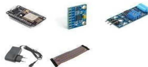
Figura 1 - Componentes utilizados para a composição do Sismógrafo
