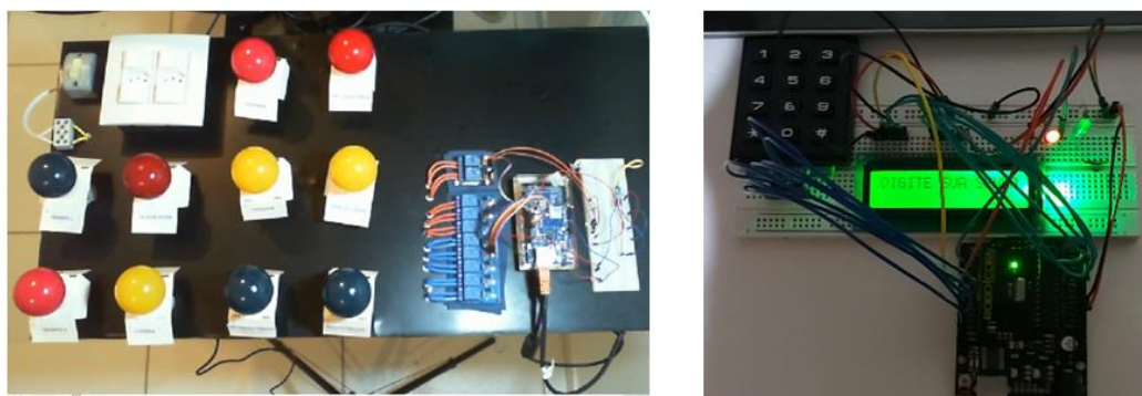
Figura 3. Montagem do protótipo. (a) Circuito de acionamento e controle da iluminação, ar-condicionado e portão com Arduino Mega. (b) Circuito de acionamento e controle da fechadura eletrônica com Arduino Uno.
