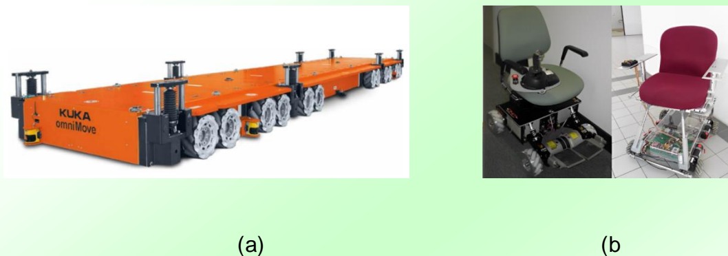
Figura 2 – Exemplos de aplicação: (a) Veículo RMO da Kuka, (b) Cadeira de rodas omnidirecionais.
