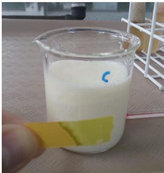
FIGURA 11: Fita medidora de pH indicando o pH do leite cru. Fonte: Autoria própria.
