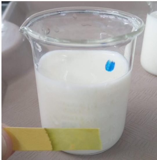
FIGURA 10: Fita medidora de pH indicando o pH do leite UHT Fonte: Autoria própria.
