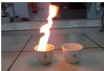
Figura 8 - Teste de combustão, cadinho contendo óleo de soja e biodiesel.
