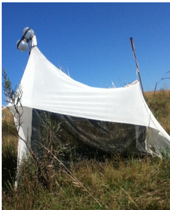
Figura 02- Armadilha Malaise instalada em campo. Fonte: Autores
