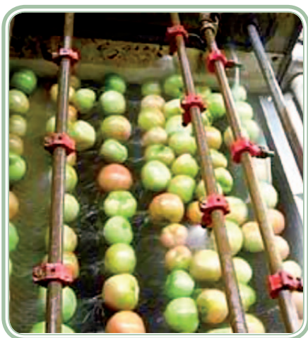
Figura 5.3: Lavagem por spray
