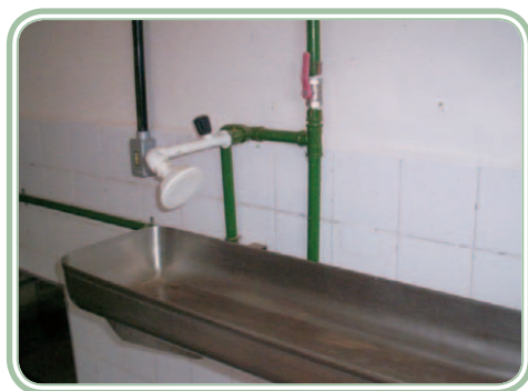
Figura 4.9: Mesa metálica para inspeção de vísceras com adaptação de fontes de água para remoção de sujidades
