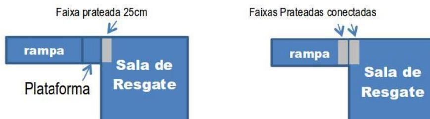
Figura 5 – Faixa prateada na entrada da sala de resgate com e sem plataforma.
