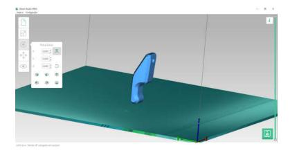
• Use o menu rotacionar conforme a figura para girar a peça na posição mais apropriada para a impressão.
